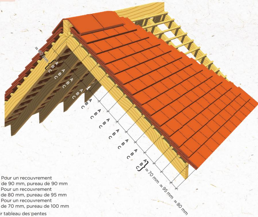
A - Pour un recouvrement de 90 mm, pureau de 90 mm
